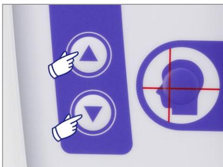
6. Utilice el dial de capa de la imagen para mover el repasador labio-nariz y alienarlo con la marca Azul; entonces asegúrelo en esa posición. Asegúrese de que el paciente mantiene una buena postura, pulse las teclas on/off de los haces para encenderlos.
